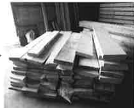
製材した松枯れ材
